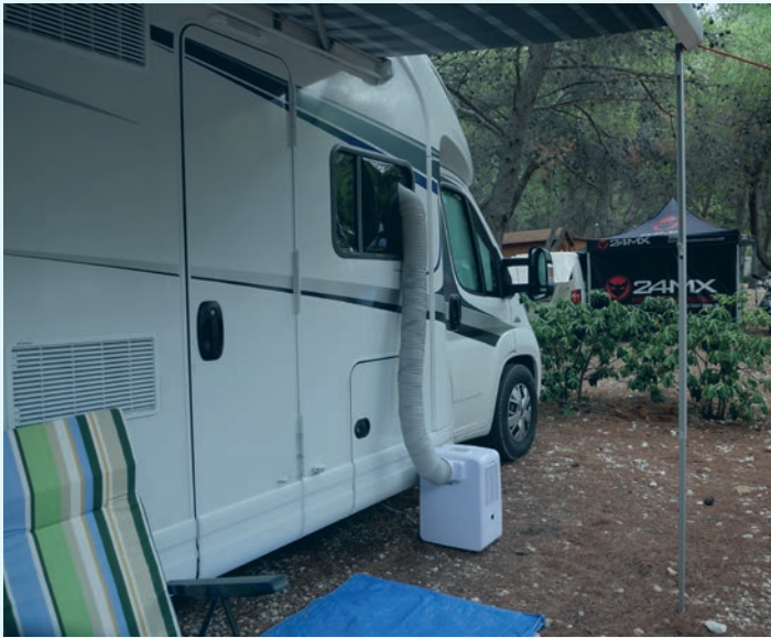
Klimatyzator z zewnątrz kampera pompuje zimne powietrze do wnętrza.
