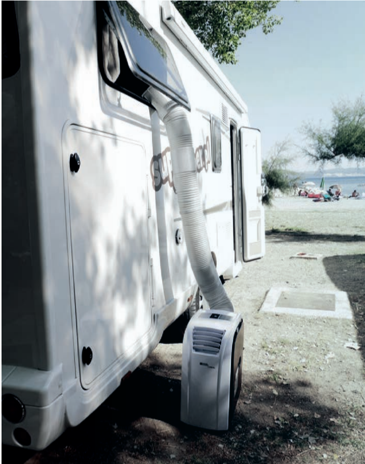
Klimatyzator z zewnątrz kampera pompuje zimne powietrze do wnętrza.
