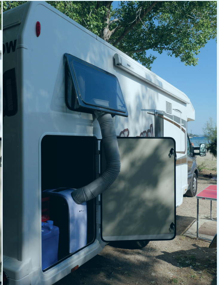
Klimatyzator pompuje zimne powietrze do wnętrza kampera z pomieszczenia technicznego.
