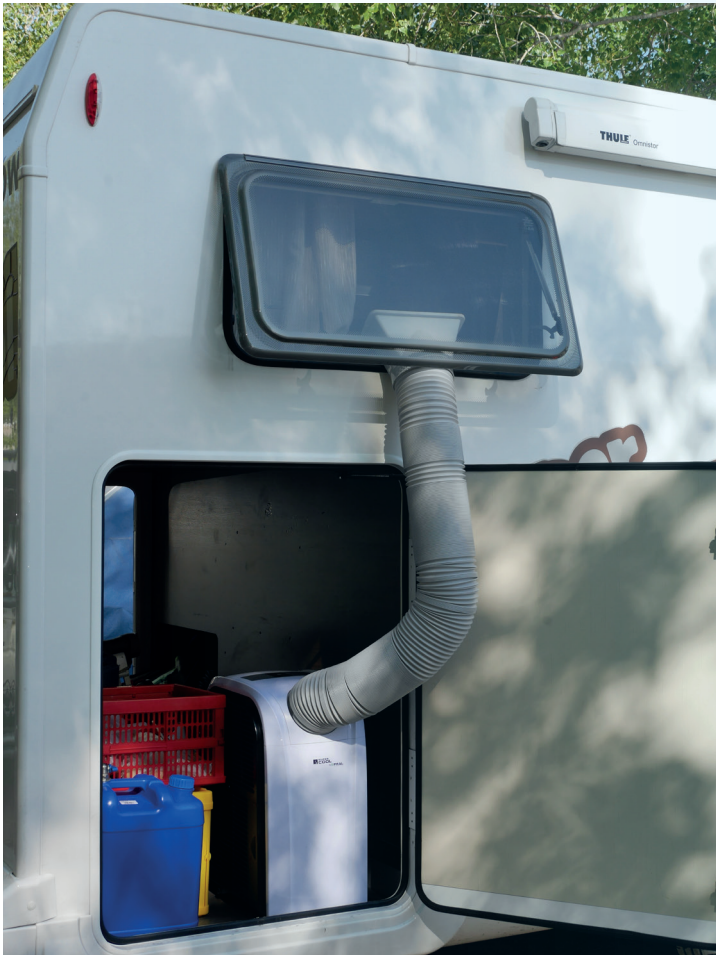
Klimatyzator pompuje zimne powietrze do wnętrza kampera z pomieszczenia technicznego.
