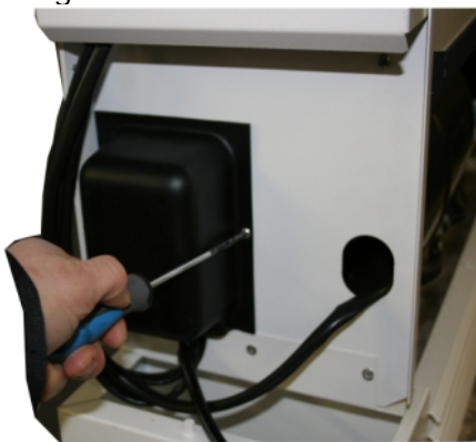
Zdjąć plastikową obudowę higrostatu
